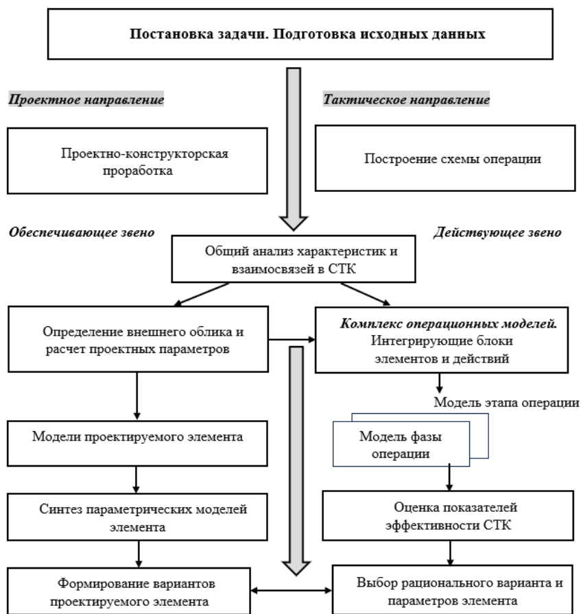
Рис. 1. Типовая блок-схема решения основной задачи проектной эффективности
