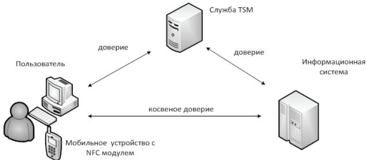
Рис. 3. Взаимодействие компонентов NFC-системы при использовании службы TSM для аутентификации пользователя в NFC-системе
