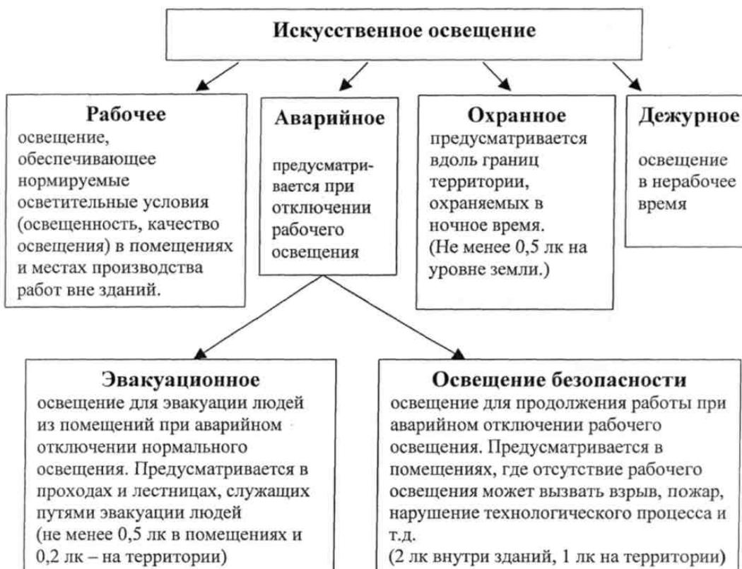
Светильники освещения безопасности могут использоваться для эвакуационного освещения. Для аварийного освещения следует применять лампы накаливания, люминесцентные лампы, разрядные лампы высокого давления.
