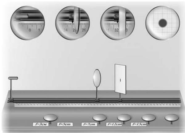
Рис. 2. Лабораторная работа по определению фокусного расстояния, диоптрической силы и увеличения собирающей линзы
