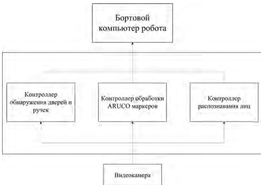
Рис. 2. Блок контроллеров обработки компьютерного зрения
