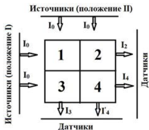
Рис. 1. Моделирование процесса просвечивания объекта при компьютерной томографии в двух положениях рентгеновского излучения [3]
