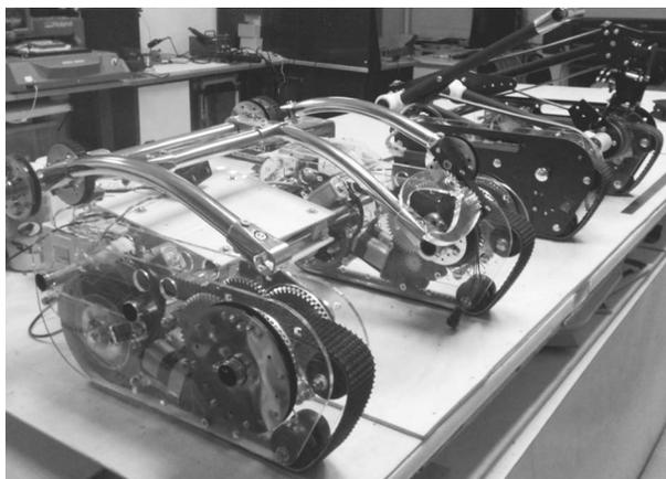
Рис. 2. Мобильные роботы Амур-307 на сборочном столе. Отработка технологии тиражирования
