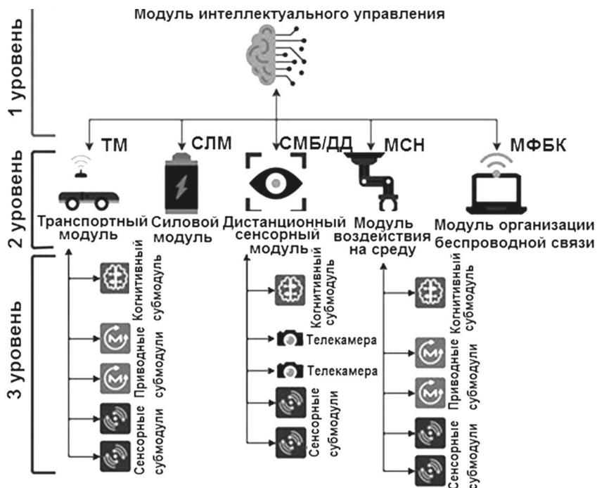
Рис. 1. Многоуровневая иерархическая сетевая топология системы управления мобильным роботом
