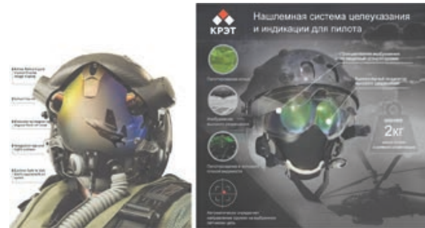
Рис. 2. Нашлемные системы целеуказания и индикации F-35 HMDS для самолёта-истребителя Lockheed Martin F-35 («Локхид-Мартин» F-35 «Молния II») и российская бинокулярная система «Охотник» для боевых вертолётов
