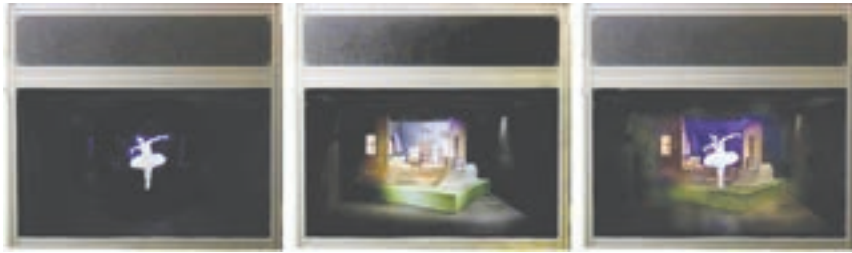
Рис. 2. Фотография экспериментального образца устройства с тремя видами изображения — виртуальным девятиракурсным объёмным изображением (балерина), с освещённым реальным объектом (макет дома) и совмещённое изображение
