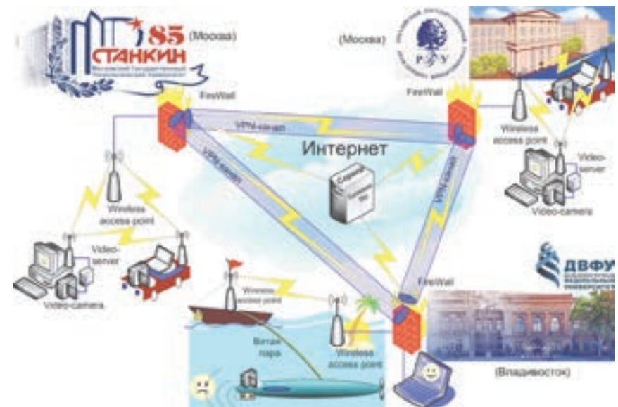
Рис. 5. Структурная схема действующей Интернет-лаборатории
