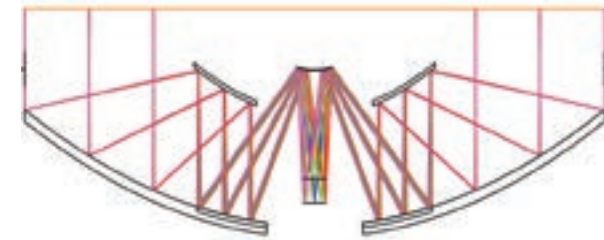
Рис. 1. Базовый вариант архитектуры оптической системы с двумя апертурами
