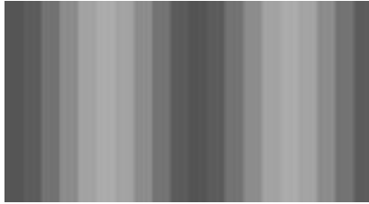
Рис. 8. Дискретное изображение E^* с ложной пространственной частотой f_x^* = -10 \text{ мм}^{-1} в дискретном изображении это изменение не проявляется.
