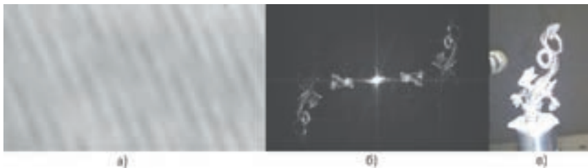
Рис. 2. Записанные голограммы: a — записанная цифровая голограмма, б — программно восстановленная цифровая голограмма кулона в форме дракона, в — кулон, использованный в качестве модели для съёмки
