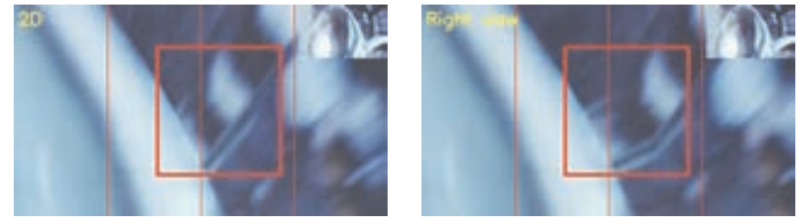
Рис. 1. Пример искажения, возникшего при неправильном заполнении областей открытия. Кадр № 85 250 из фильма «Валериан и город тысячи планет»
