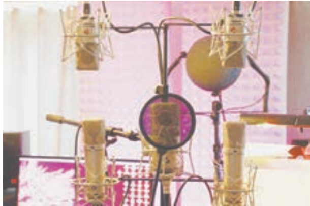
Рис. 7. Система микрофонов для певца. Микрофоны установлены так же, как и соответствующие им каналы системы Augo 3D
