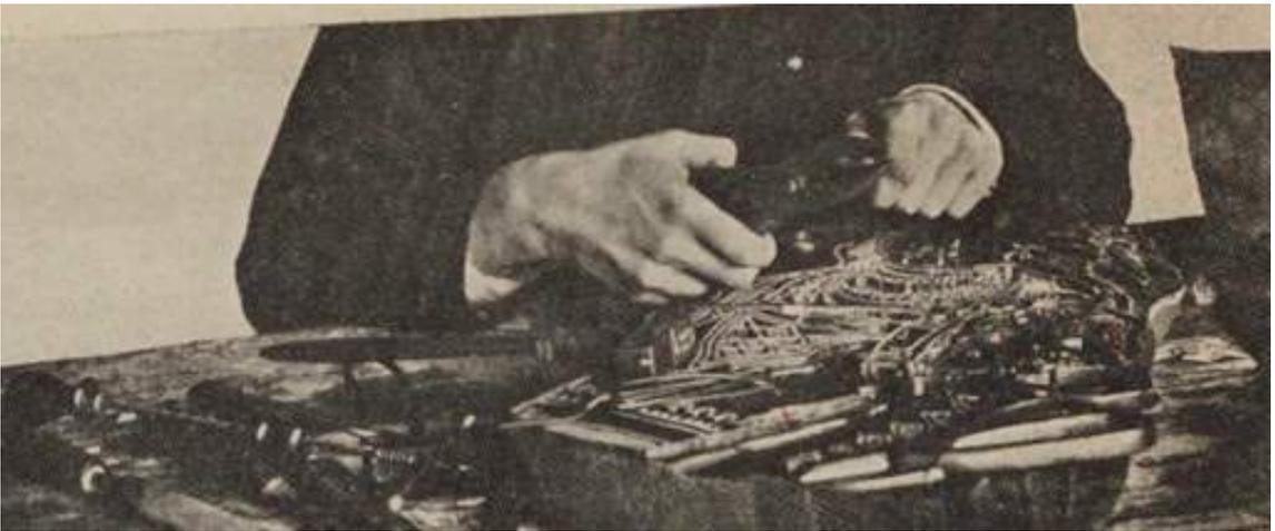
Рисунок 5.6. — Создание рельефа на деревянной форме путем инкрустации металлических пластин и иголок // Соболев Н. Н. Набойка в России. История и способ работы. М.: Тип. тов-ва И. Д. Сытина, 1912. С. 93
