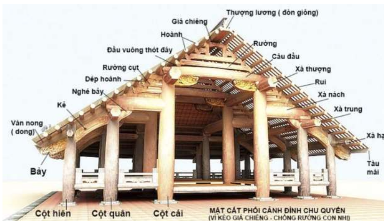
Рис. 15. Схема каркаса общинного дома с указанием названий элементов несущих конструкций. Автор: Ву Тхи Нгок Ань 112 .
