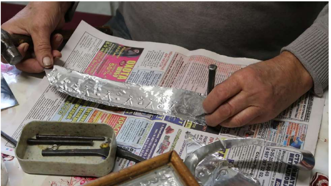
Ил. 19. Чеканка орнамента фигурными чеканами и молотком. Арзамасская традиция, мастер Александр Андреевич Пантелеев. Сфотографировано в 2021 г в п.г.т. Гремячево, гор. округа Кулебаки Нижегородской обл.
