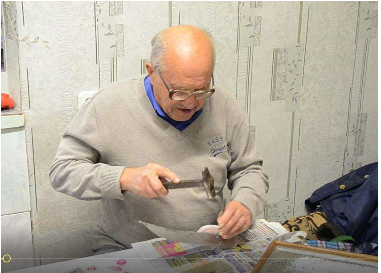
Ил. 20. Чеканка орнамента фигурными чеканами и молотком. Арзамасская традиция, мастер Александр Андреевич Пантелеев. Сфотографировано в 2021 г в п.г.т. Гремячево, гор. округа Кулебаки Нижегородской обл.
